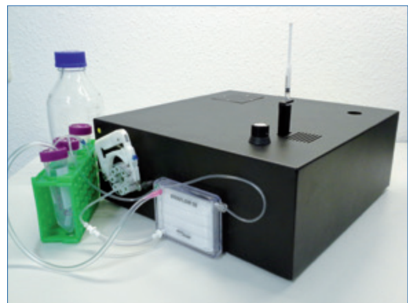
Abb. 23: Integrierte Vor-Ort-Plattform für den schnellen Nachweis von Trinkwasser-relevanten Keimen (Legionellen und Pseudomonaden). (© Analytik Jena)
