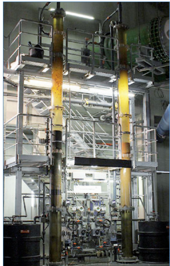
Abb. 9: Pilot-Schnellfilter in der OWA Berlin-Tegel
