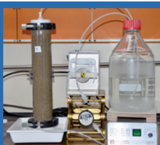
Abb. 3: Die Säule wird mit Boden gefüllt, das mit Spurenstoffen versetzte Wasser wird im Kreislauf von unten nach oben hindurch gepumpt. Nach 50 Tagen wird im Wasser nach Spurenstoffen und Abbauprodukten gesucht.
